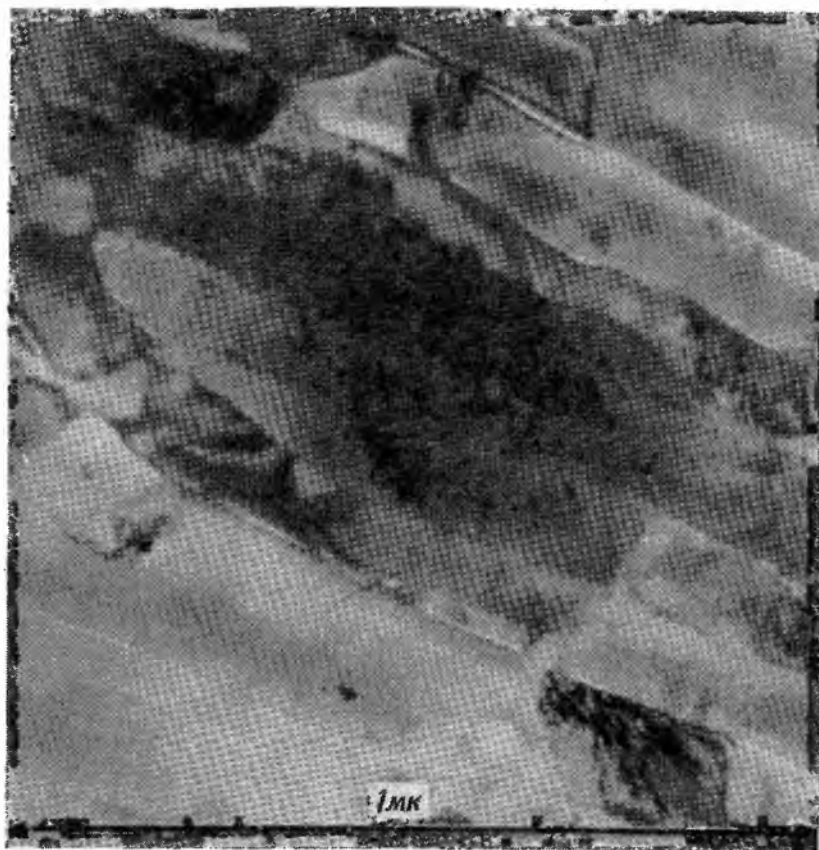
Фиг. 97. Микрофотография тонкого среза алюминия, полученного с помощью ультрамикротомы (по Эгеру). Зерна деформированы в направлении разрезания.
