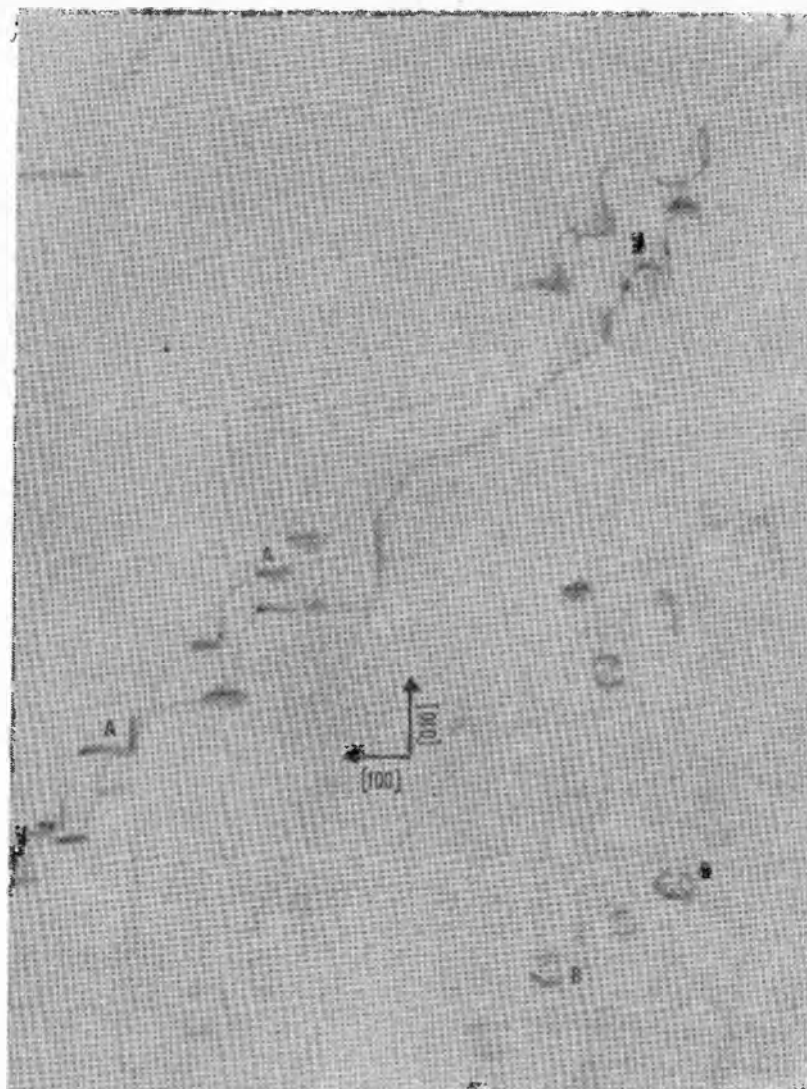
Фиг. 141. Ранняя стадия выделения \theta' -фазы на геликоидальных дислокациях AA в сплаве Al—4% Cu.
