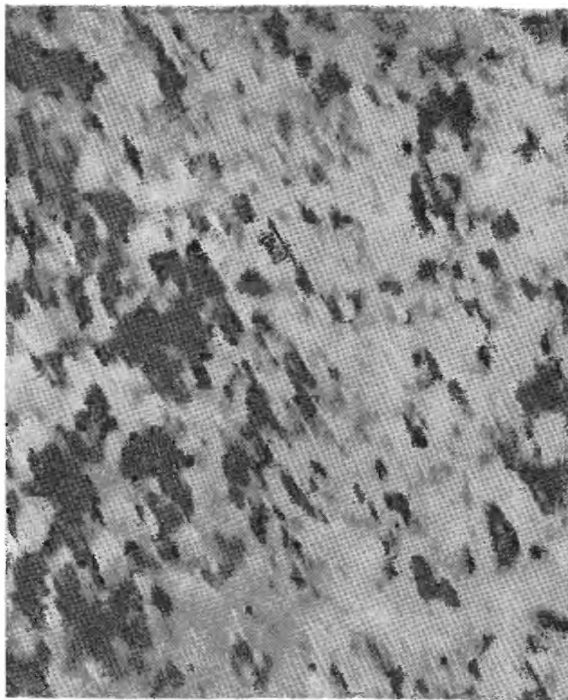
Фиг. 133. Сплав Al—4% Si, остаренный в течение 16 час при 130° С (по Никольсону и Наттингу [101]).
