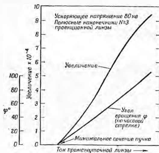
Фиг. 69. Калибровочные кривые увеличения и вращения изображения для электронного микроскопа Эльмископ I фирмы Сименс.
