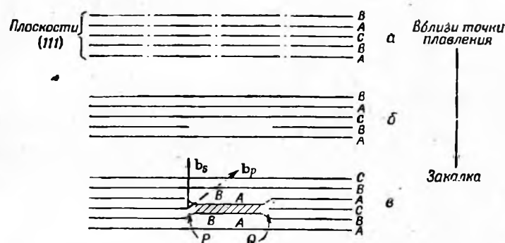
Фиг. 116. Схематическое изображение образования дислокационных петель в металлах с гранецентрированной кубической решеткой.
