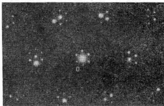
Фиг. 124. Дифракционная картина от наложенных друг на друга пленок золота, ориентированных по (111) и повернутых друг относительно друга приблизительно на 10^\circ (по Баскету и др. [79]).
