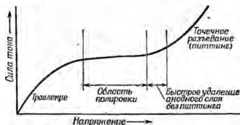
Фиг. 86. Зависимость силы тока от напряжения для электрополирующих растворов (схематически).
