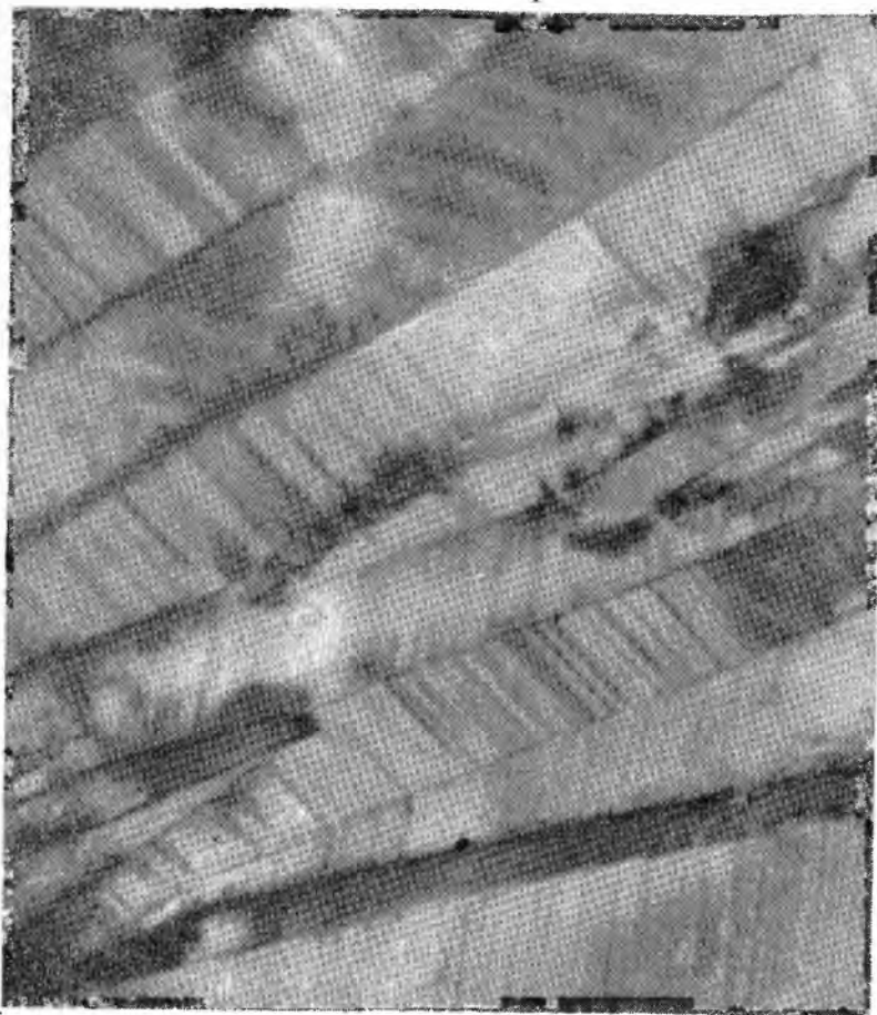
Фиг. 147. Сплав Cu — 12% Al, закаленный от 800° С. Видны дефекты упаковки внутри пластинок мартенсита. \times 40\,000 .
