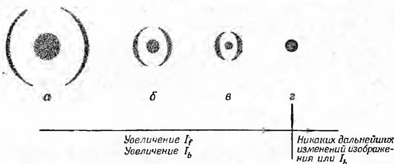
Фиг. 64. Схематическое представление изменения изображения катода (для пушки с автоматическим смещением) по мере увеличения тока накала до насыщения (по Холлу [4]).
