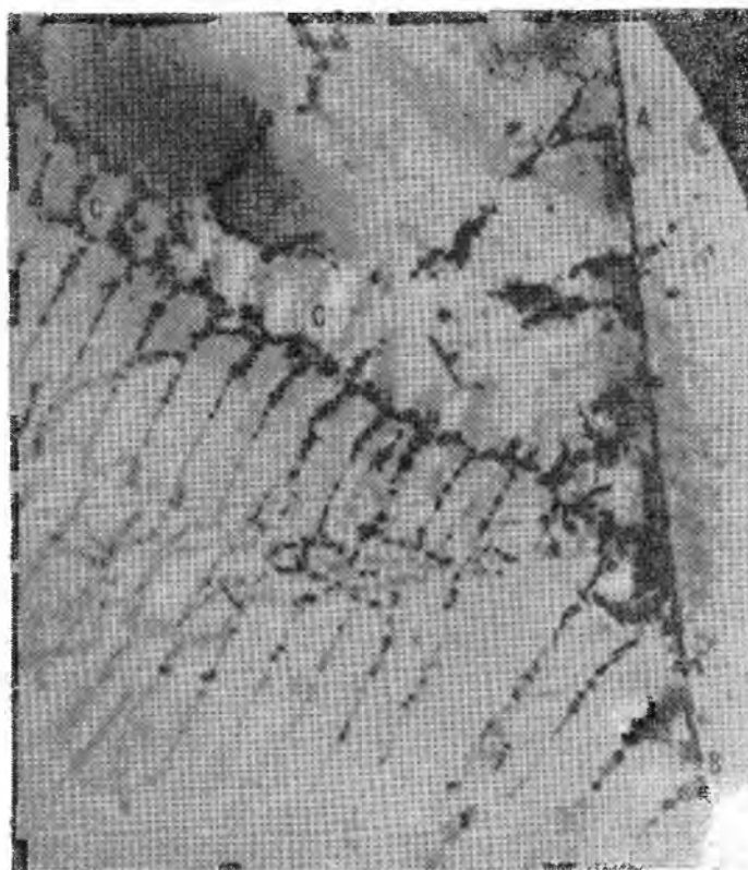
Фиг. 140. Сплав Al—3% Mg—6% Zn, остаренный в течение 5 суток при 160° С.
